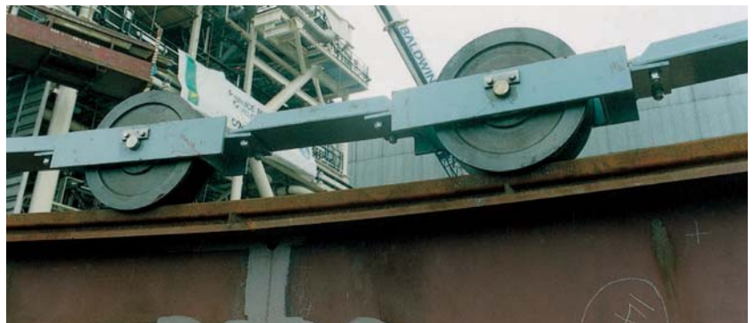
7.600 toneladas y 32 metros de diámetro, girando sobre ruedas de acero de doble pestaña sobre riel, con casquillos autolubricantes. Rueda \phi 450\text{ mm} . y ancho de banda 112 mm.
